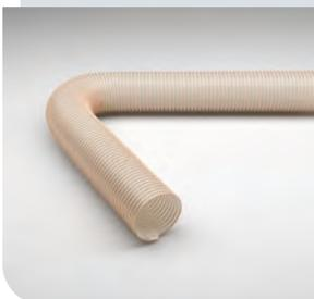
Tuyau PU d'aspiration/de transfert, souple, antistatique, résistance en surface  $<10^9$  Ohm, résistant aux agressions microbiennes, difficilement inflammable
