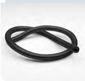
Tuyau d'aspiration et de transfert en PE-EVA, léger, résistant à l'écrasement, électriquement conducteur, résistance de surface  $< 10^6$  Ohm
