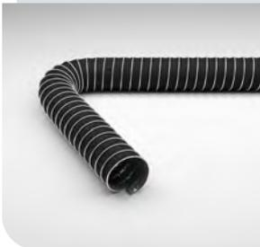
Gaine d'aspiration et de soufflage pour vapeurs corrosives jusqu'à +175 °C, électriquement conductrice, résistance de surface < 10<sup>6</sup> Ohm
