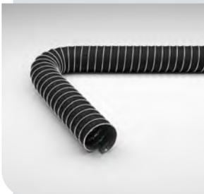
Gaine d'aspiration et de soufflage pour vapeurs corrosives jusqu'à +175°C, électriquement conductrice, résistance de surface  $< 10^6$  Ohm
