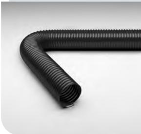
Tuyau PU d'aspiration et de transfert, lourd, bonne flexibilité, électriquement conducteur, résistance de surface  $\leq 10^4$  Ohm
