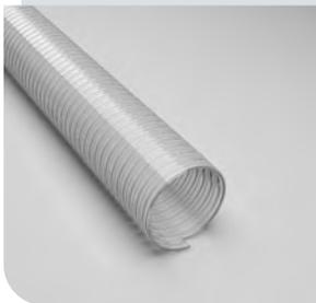
Tuyau d'aspiration et de transfert PU, très résistant à la pression et au vide, lisse à l'intérieur et à l'extérieur, antistatique, résistance de surface <math>< 10^9</math> Ohm
