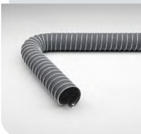
Gaine d'aspiration et de soufflage pour vapeurs corrosives jusqu'à +250 °C, électriquement conductrice, résistance de surface < 10<sup>6</sup> Ohm
