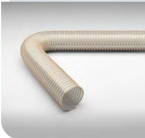
Tuyau d'aspiration/ de transfert extrêmement résistant à l'abrasion/ au vide, intérieur absolument lisse, antistatique, < 10<sup>9</sup> Ohm, résistant aux agressions microbiennes
