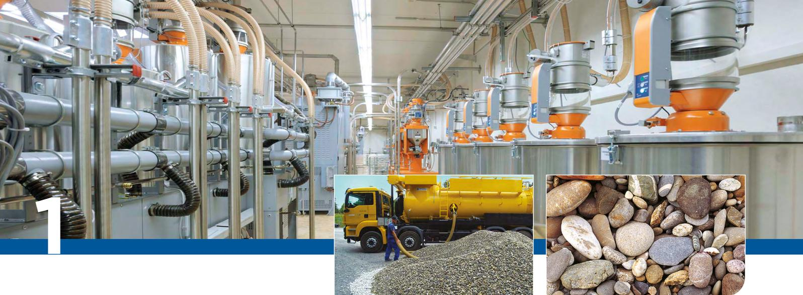
Tuyaux d'aspiration et de transfert en PU
