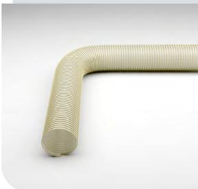
Tuyau PU d'aspiration/ de transfert, très résistant à l'abrasion/au vide, intérieur lisse, antistatique, résistance de surface < 10<sup>9</sup> Ohm, résistant aux agressions microbiennes
