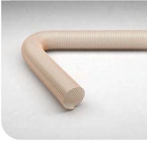
Tuyau PU d'aspiration/ de transfert, antistatique, résistance en surface < 10<sup>9</sup> Ohm, résistant aux agressions microbiennes, difficilement inflammable selon DIN 4102 B1
