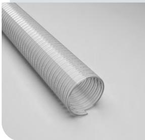
Tuyau d'aspiration et de transfert PU, très résistant à la pression et au vide, lisse à l'intérieur et à l'extérieur, antistatique, résistance de surface <math>< 10^9 \text{ Ohm}</math>
