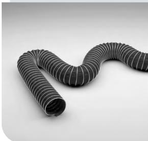
Gaine d'aspiration et de soufflage pour ventilation/climatisation, en toile polyester enduite PVC, électriquement conductrice, résistance de surface  $< 10^6$  Ohm
