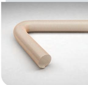
Tuyau PU d'aspiration/de transfert, souple, antistatique, résistance en surface  $< 10^9$  Ohm, résistant aux agressions microbiennes, difficilement inflammable selon DIN 4102 B1
