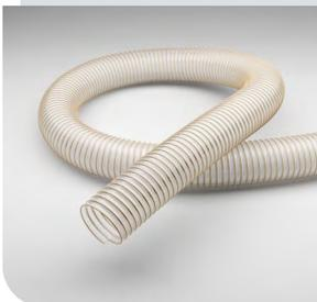
Tuyau d'aspiration/de transfert PU, très souple, antistatique, résistance en surface  $< 10^9$  Ohm, résistant aux microbes, difficilement inflammable selon DIN 4102 B1
