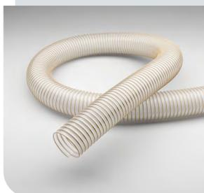
Tuyau d'aspiration/de transfert PU, très souple, antistatique, résistance en surface  $< 10^9$  Ohm, résistant aux microbes, difficilement inflammable
