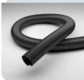
Tuyau PU d'aspiration et de transfert, léger, très bonne flexibilité, électriquement conducteur, résistance de surface  $\leq 10^4$  Ohm
