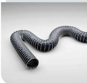
Gaine d'aspiration et de soufflage pour vapeurs corrosives jusqu'à +280°C, électriquement conductrice, résistance de surface  $< 10^6$  Ohm
