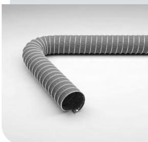
Gaine d'aspiration et de soufflage pour vapeurs corrosives jusqu'à +250°C, électriquement conductrice, résistance de surface <math>< 10^6</math> Ohm
